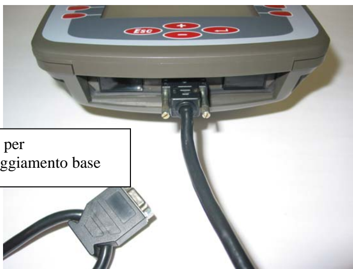
Fig. 3-8: Terminale ECO con cavo di collegamento del joystick e attacco per l'equipaggiamento base
