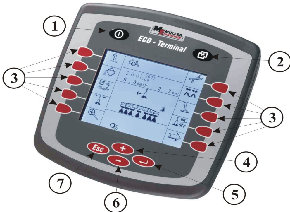
Abb. 4-1: Elementos del manejo del ECO-Terminal
