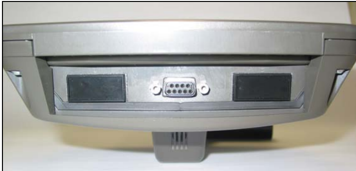
Abb. 3-6: Conexión en la parte inferior ECO - Terminal
