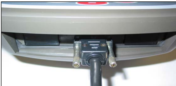
Abb. 3-7: ECO - Terminal con cable conectado del equipo básico
