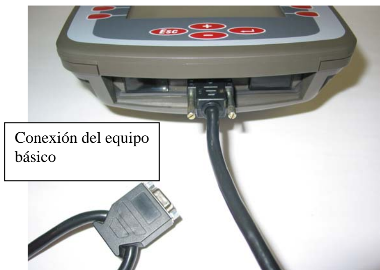
Abb. 3-8: ECO - Terminal con cable de conexión del agarrador multifuncional y conexión para el equipo básico
