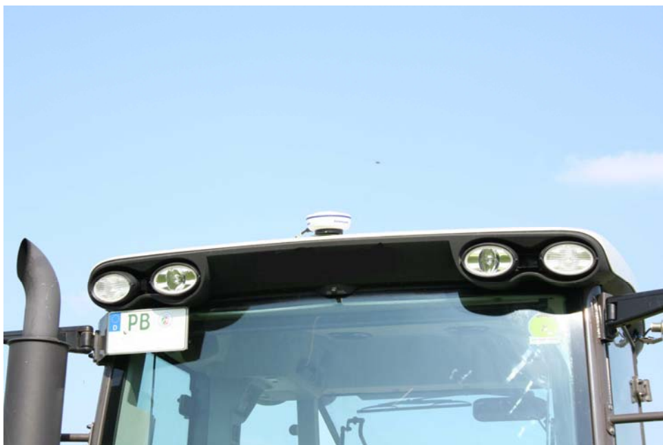
Рис.5-28 Установка антенны GPS
