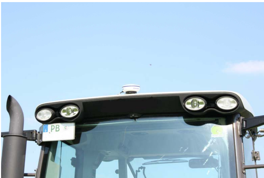
Fig.5-1 Montaggio dell'antenna GPS
