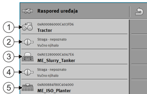
Esempio di disposizione macchine in ISOBUS-TC con spandiliquame e seminatrice di precisione
