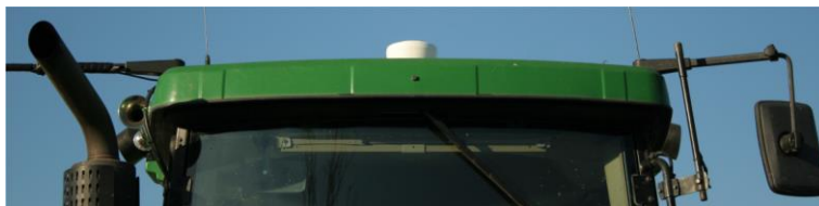
Receptor GPS sobre el techo de un tractor
