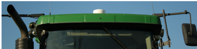
GPS imtuvas ant traktoriaus kabinos stogo
