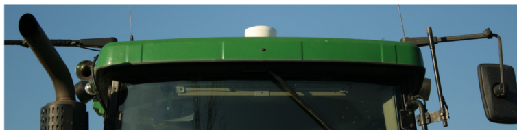
Přijímač GPS na střeše traktoru
