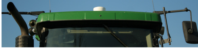
Bir traktörün çatısı üzerindeki GPS Alıcısı
