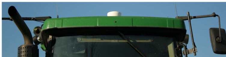
GPS mottagare på taket på en traktor
