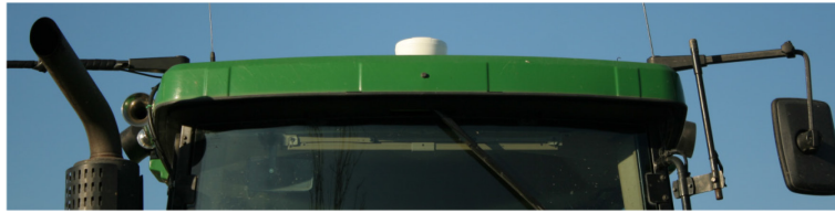
GPS imtuvas ant traktoriaus kabinos stogo
