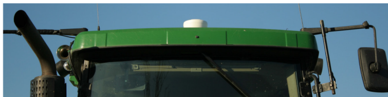
Ricevitore GPS montato sul tetto di un trattore
