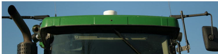
Přijímač GPS na střeše traktoru
