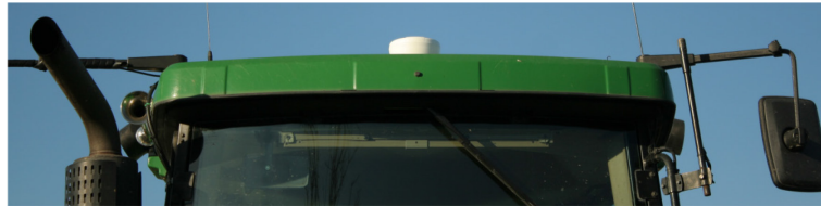
GPS-Empfänger auf dem Dach eines Traktors
