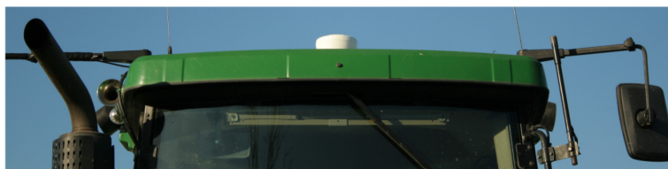
Receptor DGPS sobre o teto de um trator
