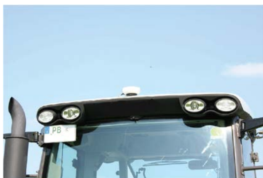
Přijímač DGPS na střeše kabiny traktoru
