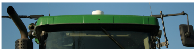
DGPS приемник върху покрива на трактор
