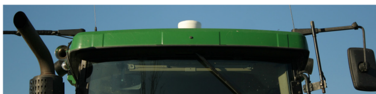
DGPS-Empfänger auf dem Dach eines Traktors
