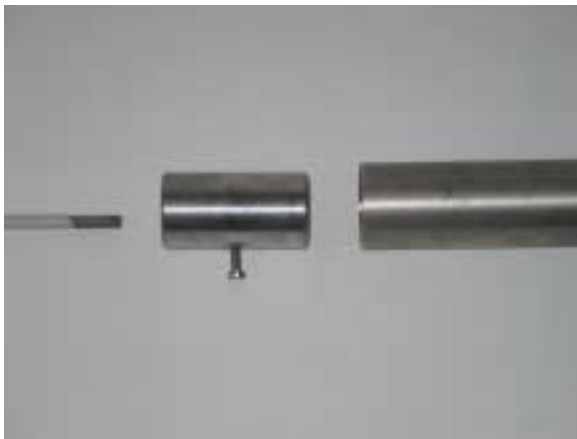
Abb. 5-4 Montage der Zusatzgewichte
