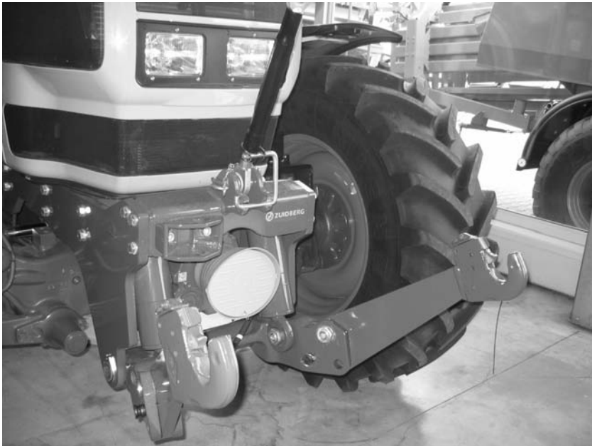
Abb. 4-1 Traktor mit Frontheber
