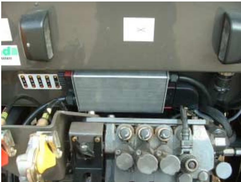
Abb. 4-1: Montage des Traktor-Jobrechners an der Kabinenrückseite
